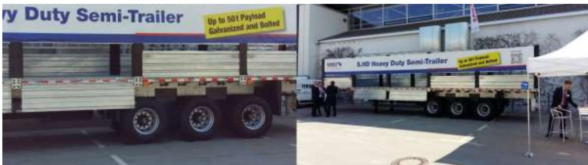
A Schmitz CargoBull, da Alemanha, lançou uma linha de reboques e semi-reboques muito modernos e funcionais. A maior parte da carroceria é de alumínio, com parte estrutural em aço galvanizado. O objetivo: ter uma carreta estruturalmente muito forte, mas com baixo peso.
