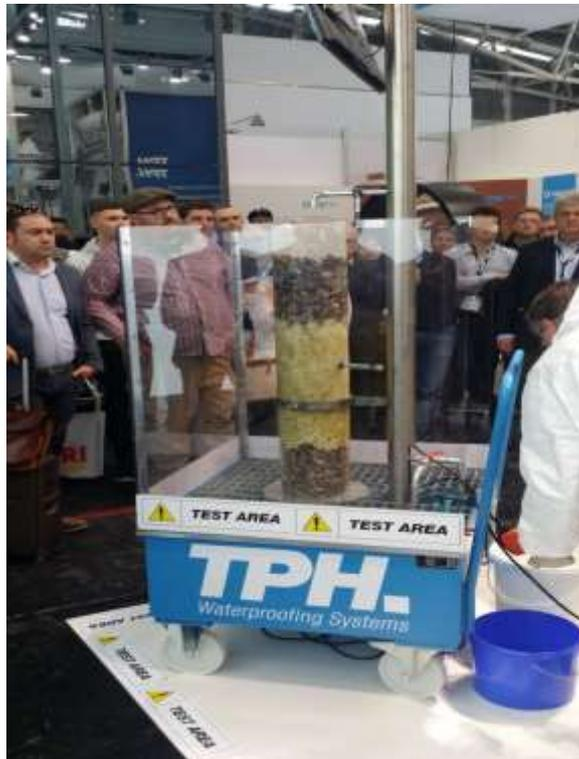
A empresa TPH apresentou demonstrações de soluções para tecnologia de injeções de produtos diversos químicos para realizar impermeabilização e renovação na área de água agressiva, como por exemplo, durante obras em túneis, estacionamentos subterrâneos, onde a água penetra frequentemente na construção através de fissuras e falhas, ou mesmo pelo poros do solo.
