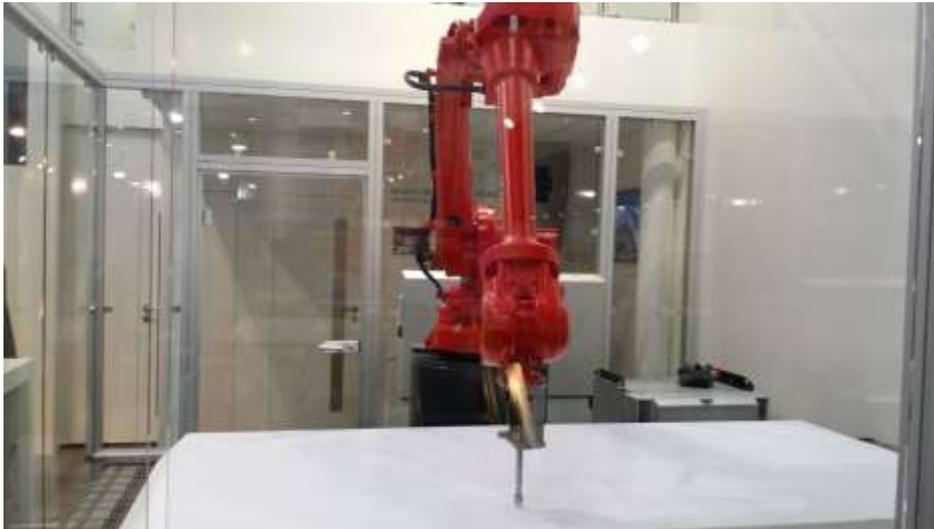
**Figura 3- Solução robótica com alta pressão para corte da placa de concreto**
